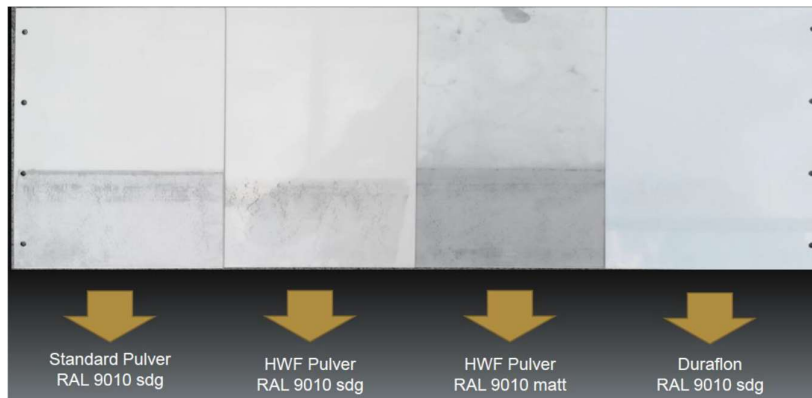
Abbildung 3: Normierte Ruß- und Reinigungstest, der die Verschmutzungsneigung der verschiedenen Oberflächen zeigt ohne vorhergehende Bewitterung.
